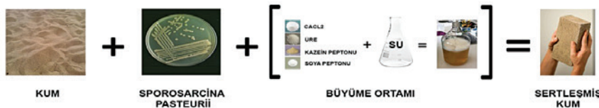
Şekil 1. Bakteriyel Biyokalsifikasyon süreci (Kişisel arşiv, 2018)
